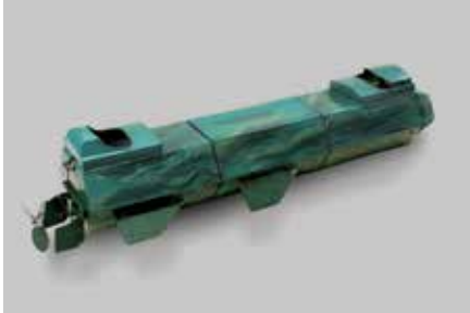
Fluchtboot Wolfgang und Manfred Kleistner, verh. Sommer 1987 Holz, Aluminium, Kunststoff, Kunstleder 370 cm lang x 108 cm breit, 86 cm hoch Inv.Nr. AK 2018/217
