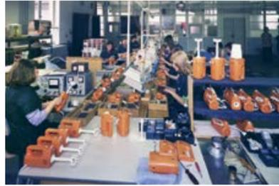
Produktion von Handrührgeräten „RG 28s“ der Marke „AKA electric“
