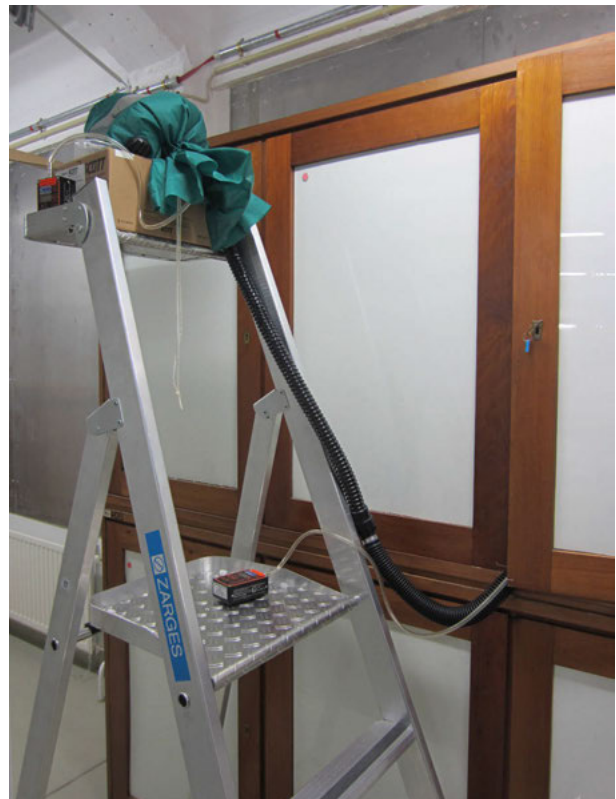
Abb. 9: Messung der gefilterten Schrankluft in der Gebläsehaube.
