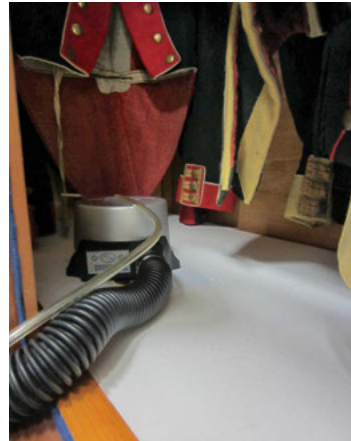
Abb. 8: Luftfiltermessung, Position des Atemluftfilters im Schrank.
