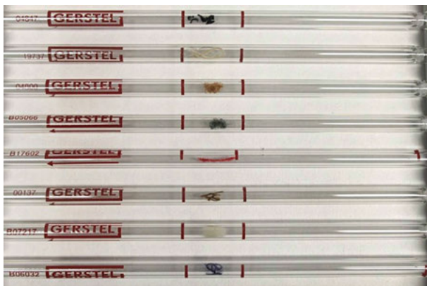
Abb. 3: Glasrohre mit Faserproben für die thermische Extraktion.
